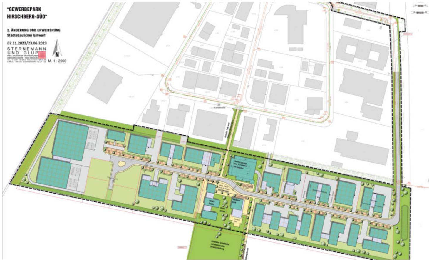
Das städtebauliche Konzept sieht unterschiedliche Grundstücksgrößen für das zehn Hektar große Erweiterungsareal südlich des bestehenden Gewerbegebiets vor. Diese bewegen sich zwischen 1500 Quadratmetern und 1,5 Hektar. Plan: Sternemann und Glup
